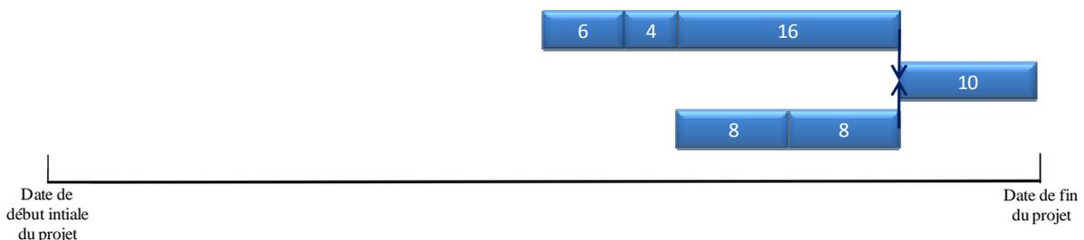
La durée du projet, définie par le « chemin critique » est donc réduite de moitié. Il est par conséquent possible, en respectant la durée initiale du projet, de programmer un « tampon projet » permettant de mutualiser les risques de retard de l'ensemble des tâches.
